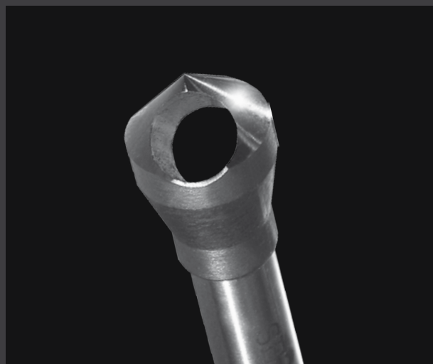
Pogłębiacz czołowy KOMET® SE Krawędź tnąca jest tworzona poprzez specjalne wykonanie przy stożku zagłębiania.
